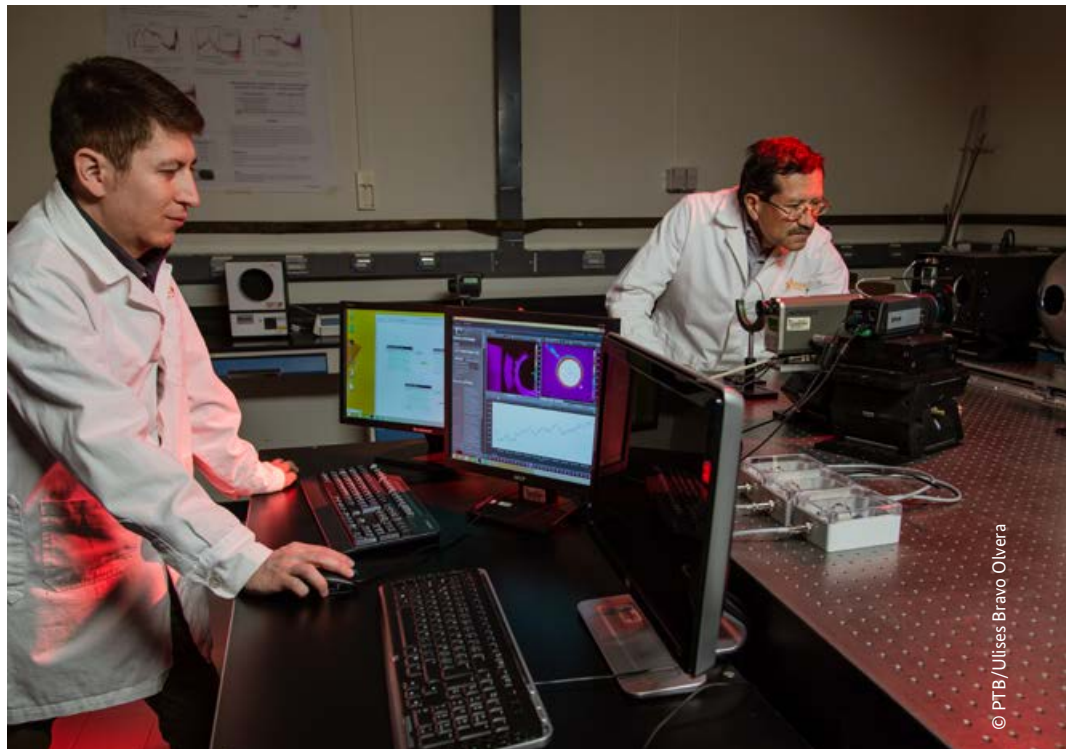
En este laboratorio del CENAM se mantiene al patrón primario para la medición de temperaturas mayores a 961,78 °C que es el origen de la trazabilidad en México para proveer referencias confiables para las mediciones de temperatura por termometría de radiación. En la foto de izq. a der.: David Cywiak Córdova, Metrólogo – Especialidad de Termometría de Radiación y Emisividad, José Efraín Hernández López, Metrólogo – Especialidad de Termometría de Radiación.
