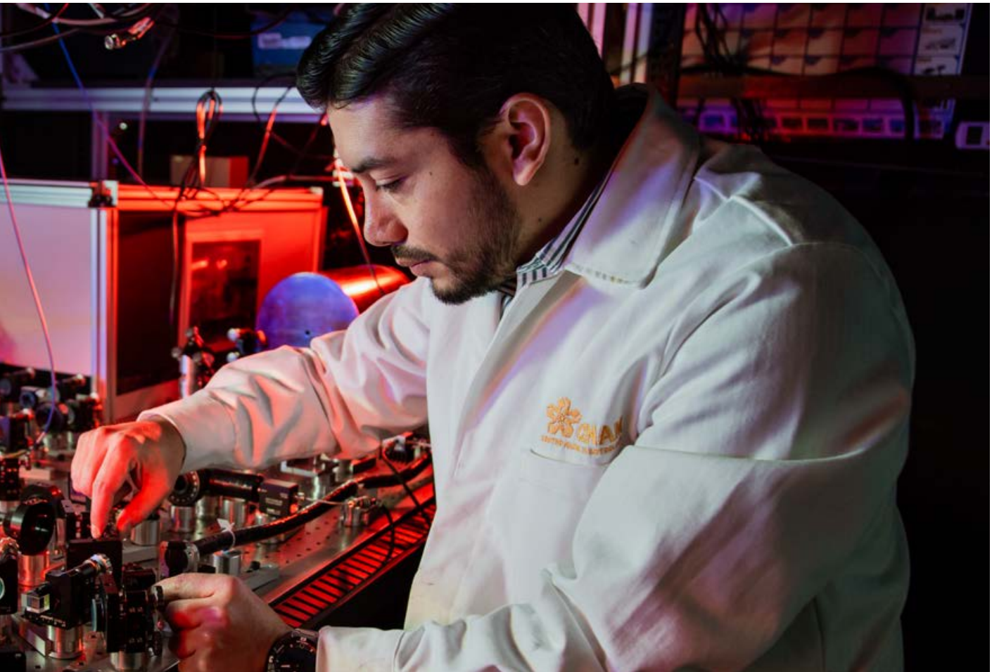
Fuente atómica o reloj de átomos fríos del CENAM. Se trata de un proyecto de largo alcance que tiene como objetivo la reproducción primaria de la unidad de tiempo. En la foto: Carlos Andrés Ortiz Cardona, Coordinador Científico – Grupo de Tiempo y Frecuencia.
