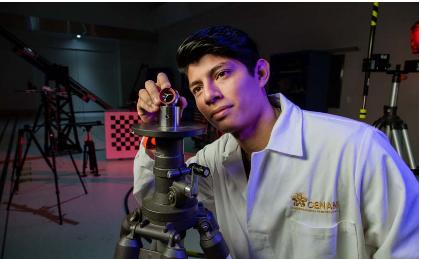
Para evaluar el desempeño de Laser trackers mediante patrones prototipo, y prestar servicios de medición y caracterización de patrones y prototipos con geometrías complejas el CENAM tiene un laboratorio con ambiente controlado, equipado con un láser Tracker con alcance de medición de 80 m radiales. En la foto: Iván Espinosa Nulutagua, Metrólogo – Especialidad de Forma e Instrumentos Industriales.
