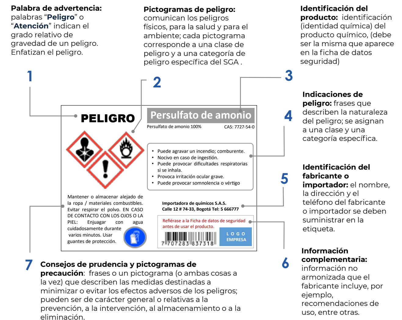
Figura 11. Elementos de una etiqueta de productos químicos de acuerdo con el SGA
